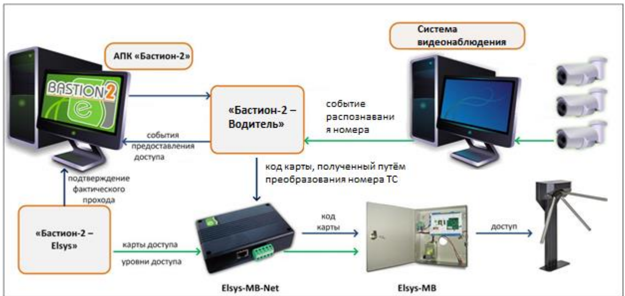
Рис. 2. Схема работы авторизации водителя в СКУД в режиме идентификации
