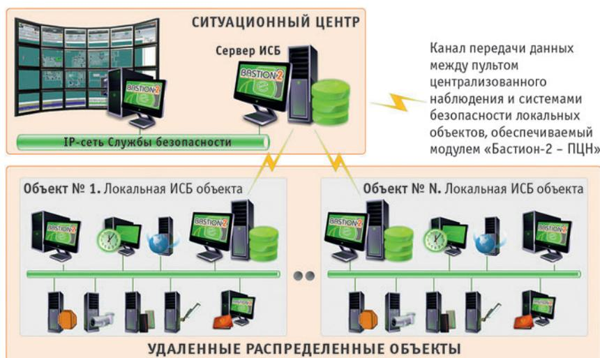
Рис. 1. Схема двухуровневой распределенной системы безопасности с использованием АПК «Бастион-2»
