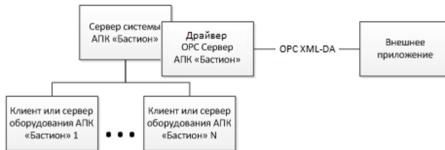
Рис. 1. Схема интеграции с использованием OPC Сервера АПК «Бастион-2»
